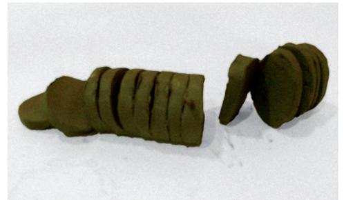
Para executar esta limpeza, após dividirmos a argila em várias rodelas, vamos amassá-las, uma a uma, com os dedos, espremendo-as, sentindo e detectando os detritos, para, então, retirá-los da massa.
