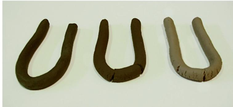
Da esquerda para a direita, temos exemplos de argila, silte arenoso (massapé amarelo) e o caulim. Observe as quantidades de rachaduras nas curvas; quanto maior a quantidade delas, menor é a plasticidade do material.
