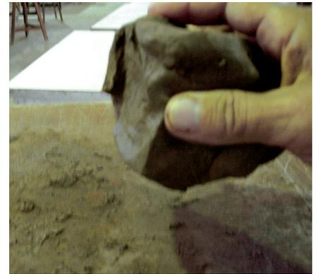
Quando colocamos a argila no ponto de trabalho, vamos, então, iniciar um processo de limpeza, objetivando retirar as impurezas da argila, pedrinhas e qualquer tipo de detrito rígido que não seja argila são retirados. Para isto, fazemos uso de um arame esticado entre dois suportes de madeira para fatiar a argila. Observe-se que quando compramos argila já preparada este processo não se faz necessário.
