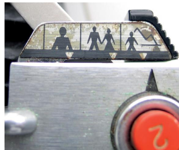
Figura 17. Detalhe de uma Câmera com opção de ajuste de foco.
