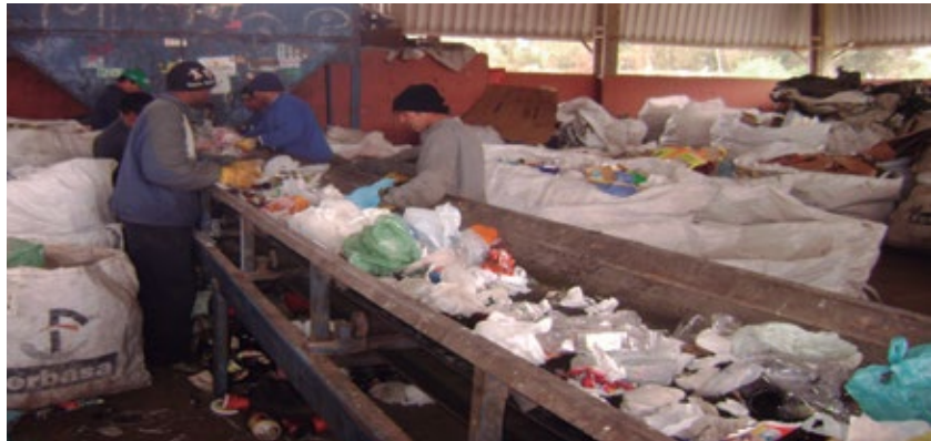
Figura 2. Etapas de separação do lixo na usina de reciclagem.
