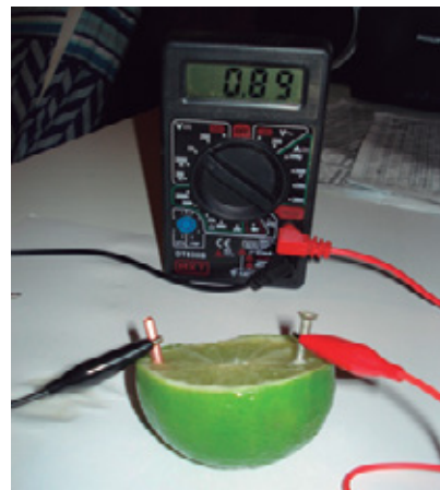
FIGURA 5: a) Uso do voltímetro para medir a ddp da “pilha de limão”; b) “Pilhas de limão” ligadas em série (1,82V).
