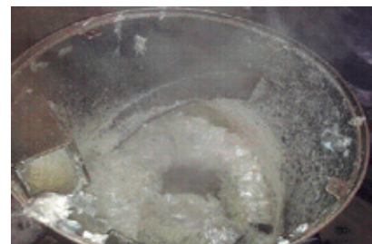
FIGURA 10: Início do processo de aglutinação nos cestos rotativos das sacolas plásticas já picotadas, limpas e secas na indústria Rio Novo – Serra – ES.
