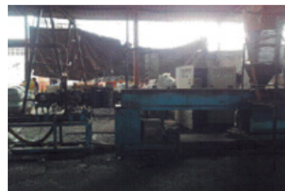
FIGURA 13: Equipamento em que a massa plástica é transformada em um "espaguete" contínuo para posterior resfriamento para formação dos pellets (grãos de plásticos) após picotagem, indústria Rio Novo – Serra – ES.
