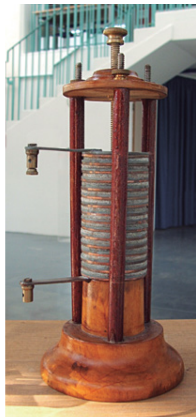
FIGURA 2: Pilha desenvolvida por Alexandre Volta – 1800. Fonte: http://de.academic.ru/dic.nsf/ dewiki/1473656
