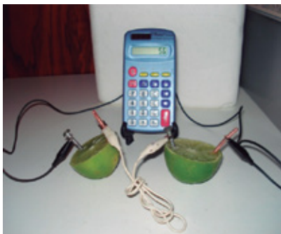
FIGURA 6: Calculadora conectada às "pilhas de limão" em funcionamento.
